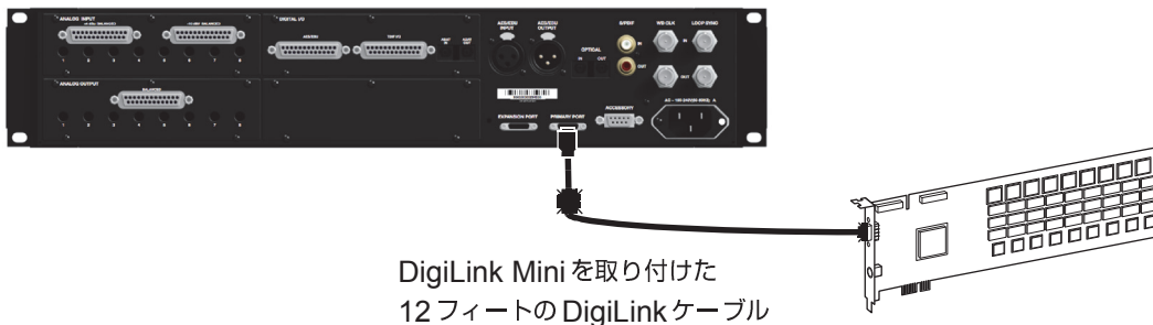
図 5. Pro Tools|HD Accel CoreカードのDigiLink Portへ接続したHD I/O(16チャンネルのI/Oシステム)
